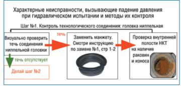
Этап 3. Разработка инструкции по устранению неисправностей
