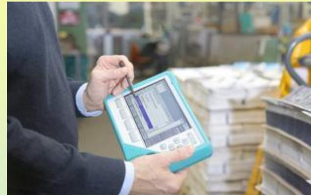
Устройство позволяет надежно прочитывать на сенсорном экране даже при ярком солнечном свете и остром угле видимости. Может обслуживаться в перчатках.
